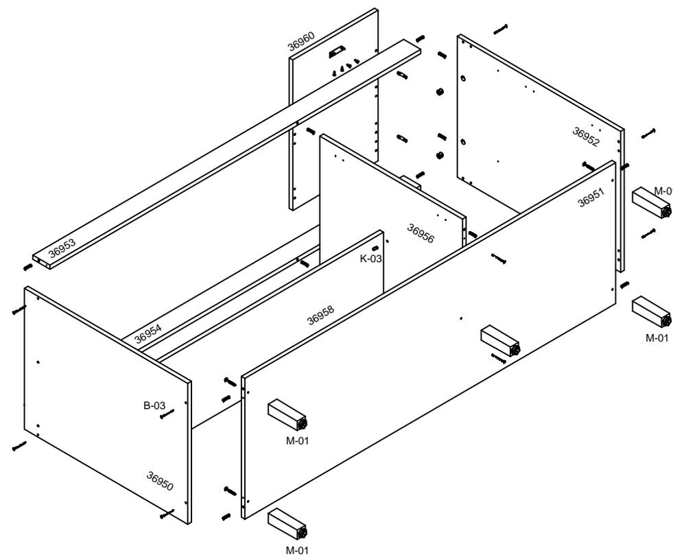
**Passo 3:** Usar cavilhas e parafusos para unir a segunda parte da estrutura. Usar parafusos **B-06** para unir os pés. Para melhor acabamento, usar tampas de parafusos **D-04** nos parafusos **B-03**.
