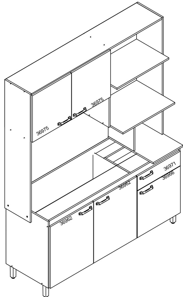
**Passo 6:** Usar dobradiças e calços para fixar portas. Usar parafusos **B-04** para fixar os puxadores **H-14**.
