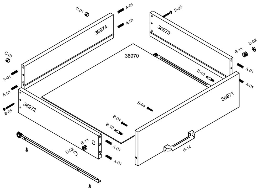
**Passo 2:** Usar cavilhas a parafusos para montar a primeira parte da estrutura. Para melhor acabamento, usar tampas de parafusos **D-04** nos parafusos **B-03**.
