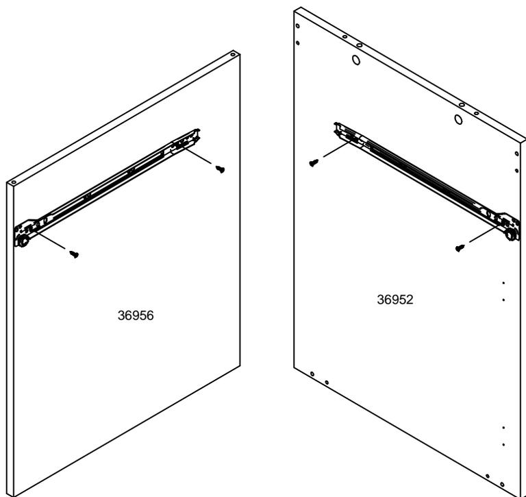
**Passo 5:** Fixar as costas com parafusos **B-08** (área destacada), pregos, fixadores de costa e perfil H.
