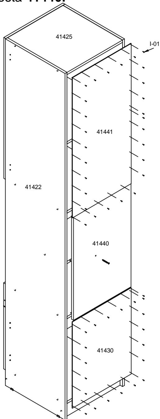
**Passo 1:** Fixar as corredeiras E-04 com parafusos B-08. Usar parafusos B-03, tambores e cavilhas para montagem da gaveta.
