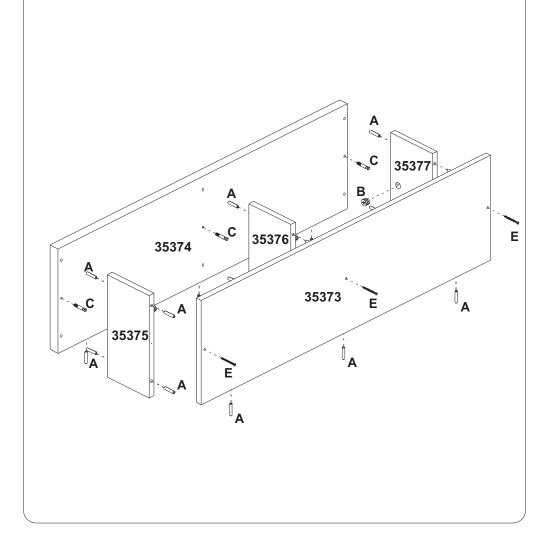
Passo 2: Fixar os painéis superior e inferior com parafusos 3,5 x 14 c/c na junção metálica , encaixando nas cavilhas que já estão fixadas no painel traseiro, como mostra no passo seguinte. 35371 35372
