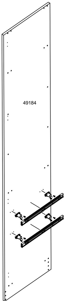
**Passo 5:** Para montagem das portas, atenção para usar as dobradiças de **colo alto** nas portas do meio, usar as dobradiças de **colo baixo** nas portas laterais e parafusos **B-08**. Usar parafusos **B-04** para fixar o puxador **H-09**.
