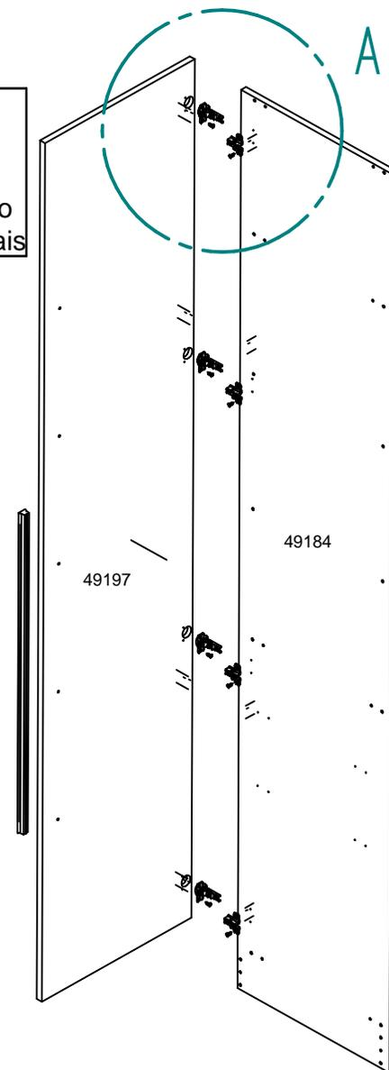
**Passo 4:** Fixar as corrediças **E-04** com parafusos **B-08**. Usar parafusos, tambores e cavilhas para montagem da gaveta.
