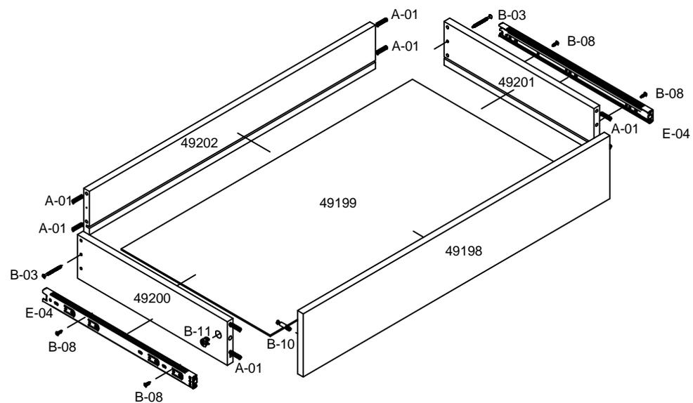
**Passo 2:** Fixar a corrediça **E-04** na divisão direita usando parafusos **B-08**.
