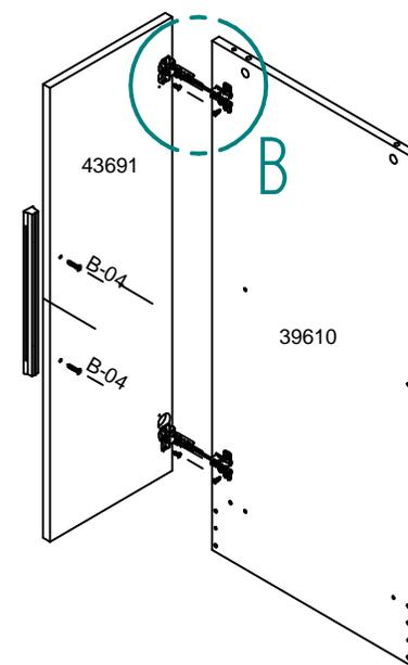
**Passo 3:** Usar cavilhas, parafusos Bigfix e tambores para montagem das laterais c/ as frentes de gaveta. Usar parafusos **B-03** e cavilhas para montagem das laterais c/ os traseiros. Usar parafusos **B-04** para fixar o puxador. Usar parafusos **B-08** para fixar as corredeiras.
